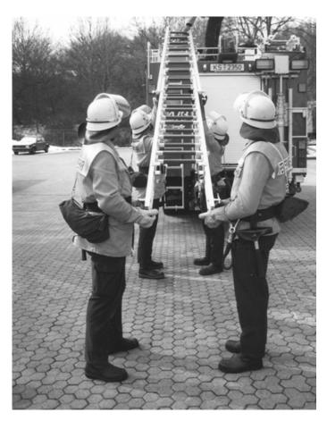
Nach Ablegen der Leiter erfolgt eine Kehrtwendung. Die oberen Leiterteile werden bis zum Kopfende der darunterliegenden Leiterteile zurückgenommen und in diese eingesteckt. Dabei hält der Trupp mit jeweils der einen Hand den Leiterfuß an den Federsperrbolzen und mit der anderen Hand den Leiterkopf an einer Sprosse.
