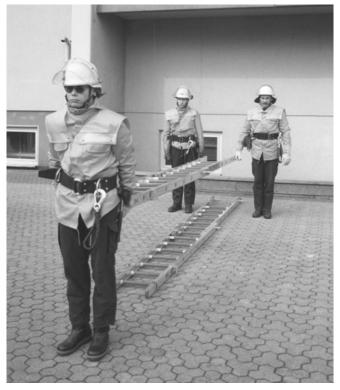
Die zusammengesteckte Leiter wird danach an die Wand des Objekts geschoben; die Federsperrbolzen an den zusammengesteckten Leiterteilen müssen nun eingerastet sein.
