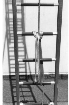
Die Leiter wird angelegt und die Stützstangen werden seitlich so ausgerichtet, daß ein Durchbiegen und seitliches Verschieben der Leiter vermieden wird. Der befohlene Trupp steigt auf und ein. Der andere Trupp sichert die Leiter an den Stützstangen.
