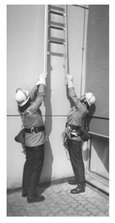
Ein weiteres Leiterteil wird vom dritten Feuerwehrangehörigen beziehungsweise vom anderen Trupp in die Kästen der hochgeschobenen Leiter eingeschoben und die Federsperrbolzen werden durch Drehen zum Einrasten gebracht.
